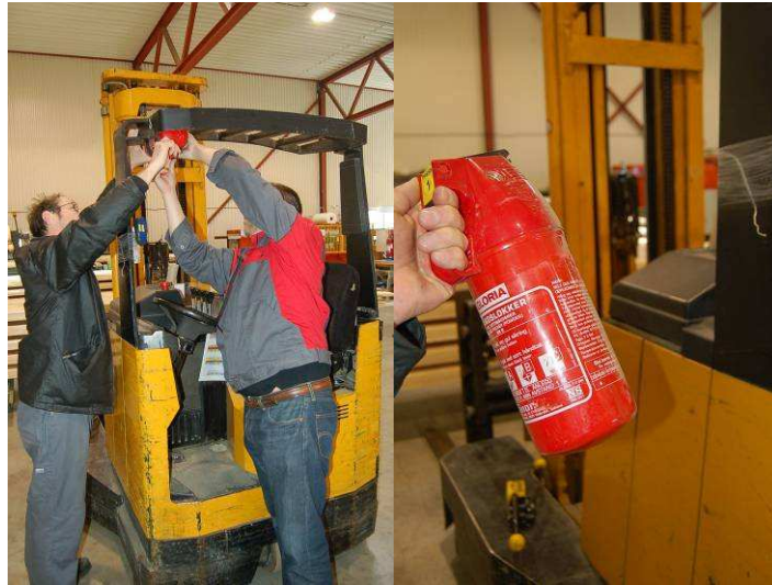
Figur 11. Alle trucker bør ha håndslukkeapparat i førerhuset. Disse må være underlagt kvalifisert kontroll.
