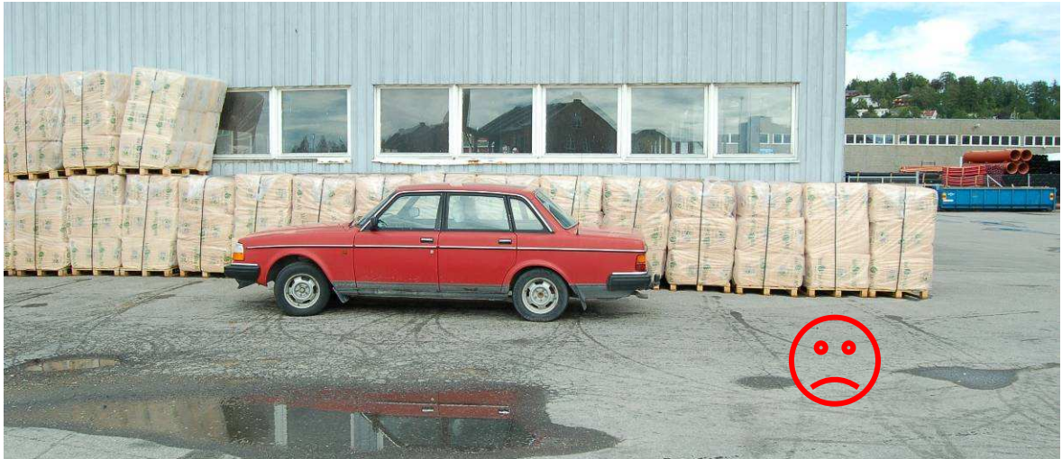
Figur 28. Ferdsel og parkering til besøkende må reguleres. Bildet viser også uheldig lagring av store mengder brannbart materiale inntil yttervegg.
