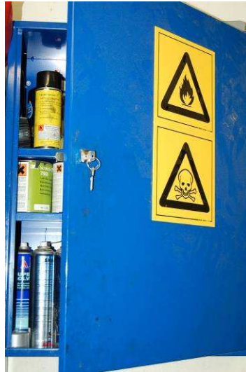
Figur 15. Sprayflasker og mindre beholdere av annen brannfarlig vare bør oppbevares i brannsikkert skap.
